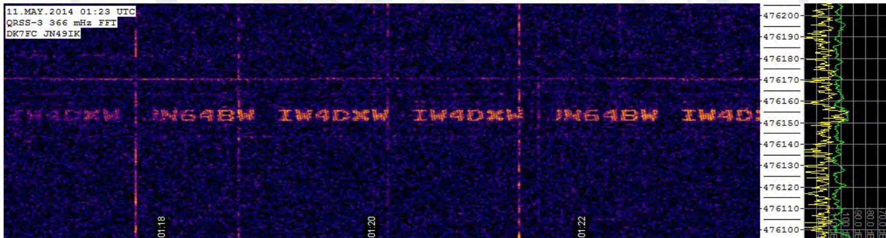
***IW4DXW** modo **S/MT-Hell** (Sequential Multi-Tone Hellschreiber) trasmissione ricevuta da **DK7FC** l'11 maggio 2014 ore 01:23 UTC. **BW=5Hz**, 8 toni, 11 secondi per carattere.*
